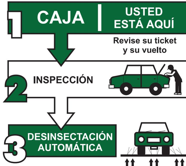
La desinsectación de vehículos se realiza con un sistema automático que pulveriza una solución con insecticida (Cipermetrina), por medio de picos que se ubican a nivel del piso. La toxicidad del insecticida utilizado es prácticamente nula para los animales de sangre caliente, siendo alta para los insectos (Ej.: mosca de los frutos).
